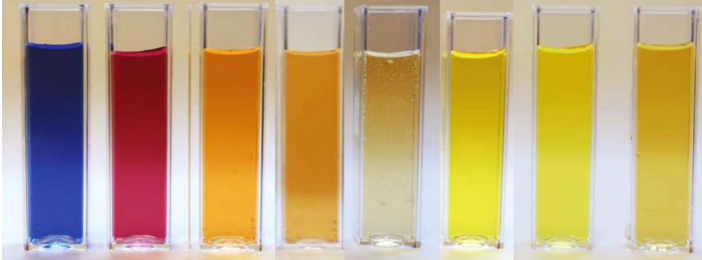
Suspension colloïdale de nanoparticules d'argent : la couleur dépend de la taille
